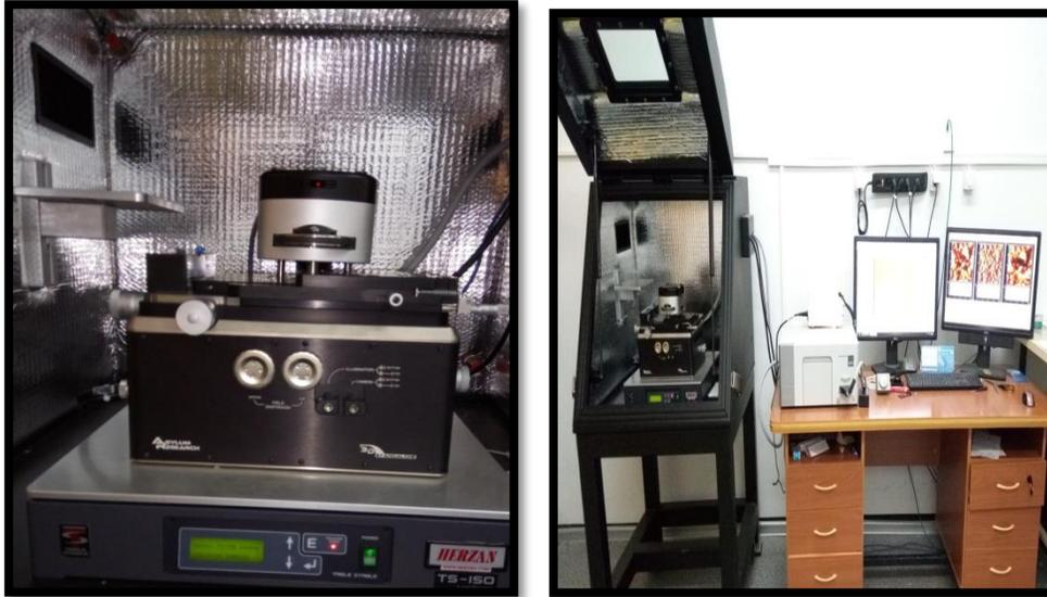
*Figure II.21 : microscope à force atomique.*
