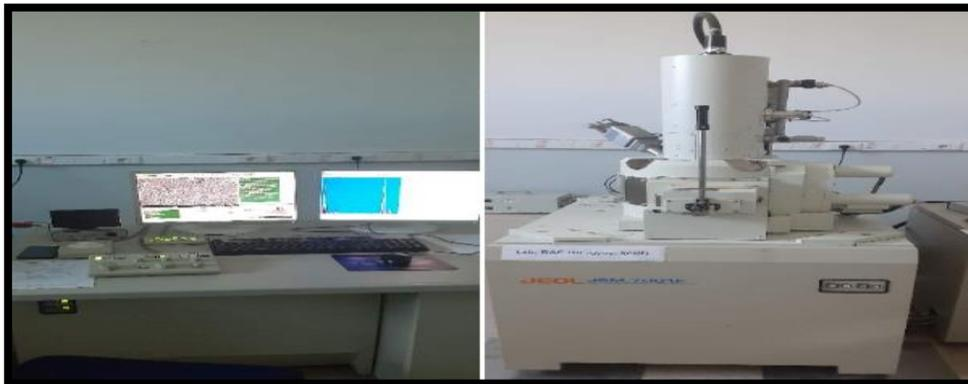
Figure II.19 : Microscope électronique à balayage (MEB) : JEOL- JSM-7001F.
