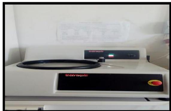
*Figure II.4 : la machine de polissage électrique.*
