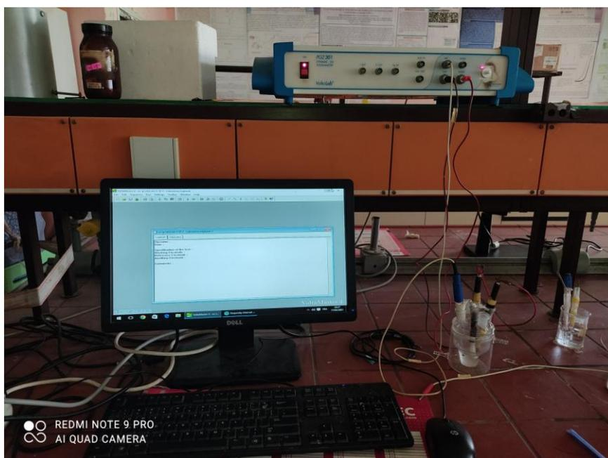
**Figure II.1.** Schéma de principe d'un montage à trois électrodes.
