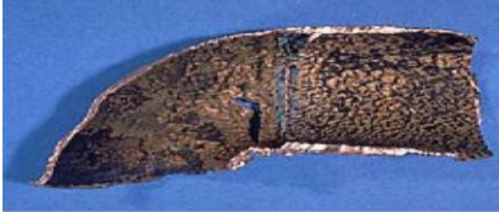
Figure 9 : Corrosion érosion d'un tube en cuivre véhiculant de l'eau [31]
