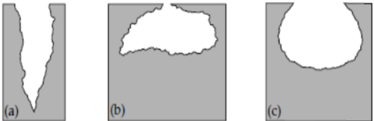
Figure 6 : Formes de piqûres (a) cavité profonde (b) cavité cavernieuse (c) hémisphérique
