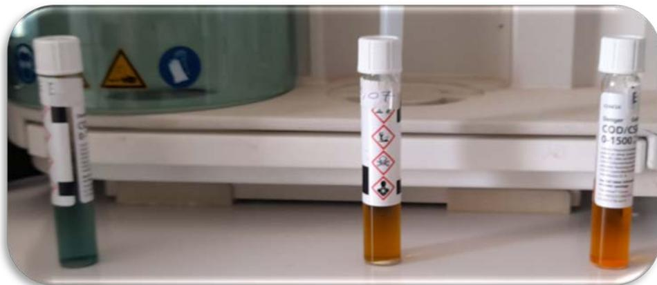
**Figure 15: Tubes des tests du dosage de DCO.**
