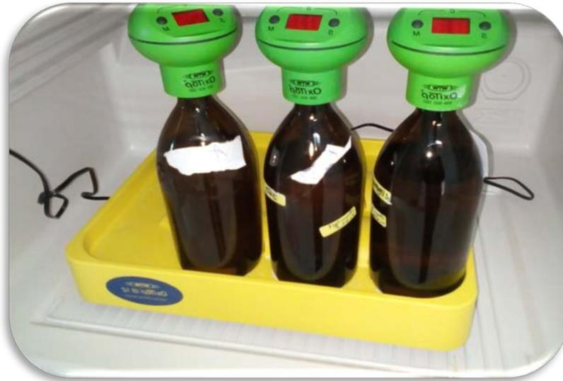
Figure 17: Flacons de mesure de DBO<sub>5</sub>.
