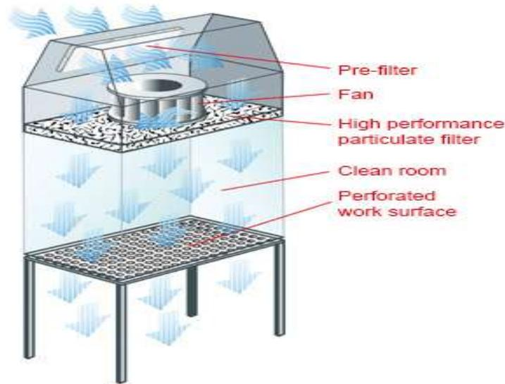
Figure. I.4: Système de diffusion par flux laminaire [4].
