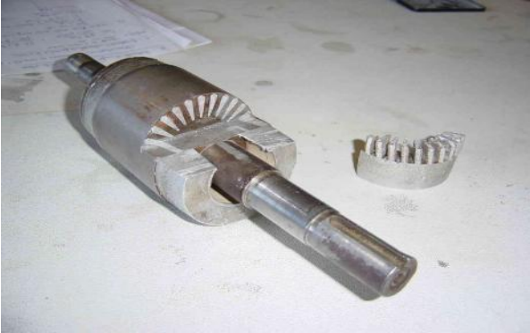
Figure (I.3) : Rotor à cage d'écreuil
