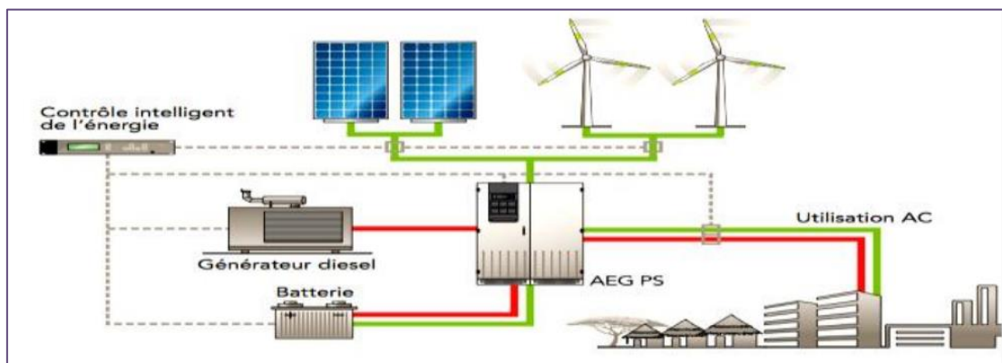
Figure 19: Schéma physique de la chaîne de conversion d'énergie électrique hybride (photovoltaïque-éolienne- groupe électrogène) .
