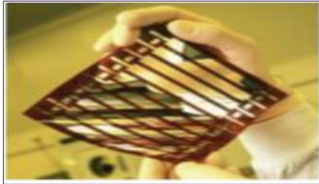
Figure 12: Cellule solaire tout organique sur substrat souple. [24]
