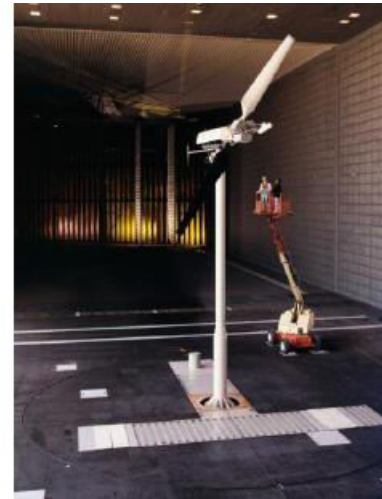
Figure IV.23: l'éolienne montée sur une tour de 12,192m au milieu de la soufflerie
