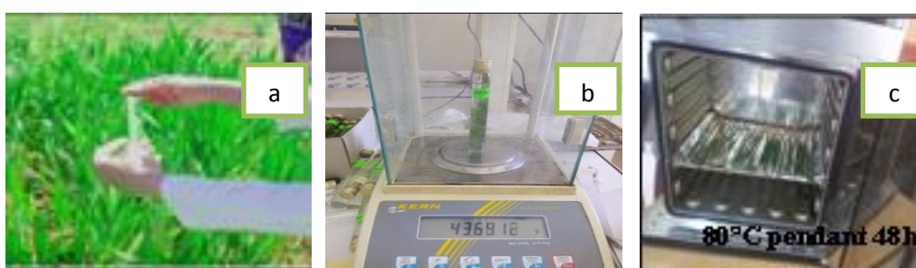
Fig 13 : Principaux étapes à suivre pour déterminer la teneur en eau (Originale, 2016).
