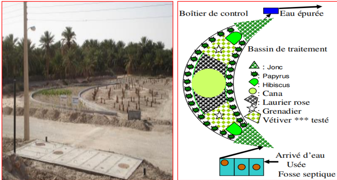
Figure 05 : Photo et présentation schématique de la station de Temacine
