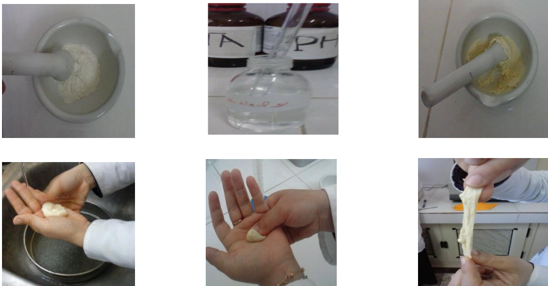
Figure n° 10 : Technique de détermination du gluten humide
