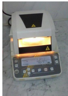
Figure n° 07 : Méthode de la détermination de l'humidité de la semoule
