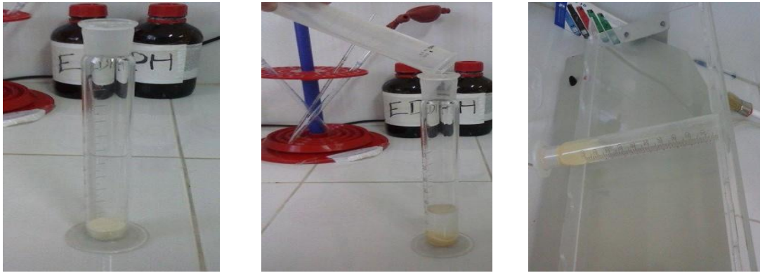
Figure n° 09 : Technique de détermination de l'acidité grasse
