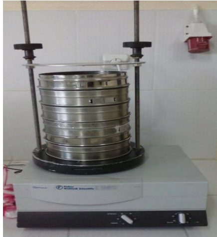
Figure n°08 : Technique de détermination de la granulométrie (Planchister)
