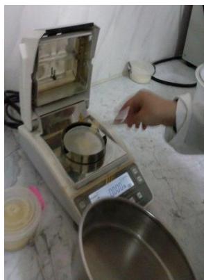
Figure n° 07 : Méthode de la détermination de l'humidité de la semoule
