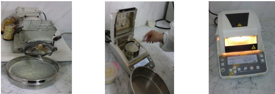
Figure n°15 : Technique de détermination de l'humidité de la semoule
