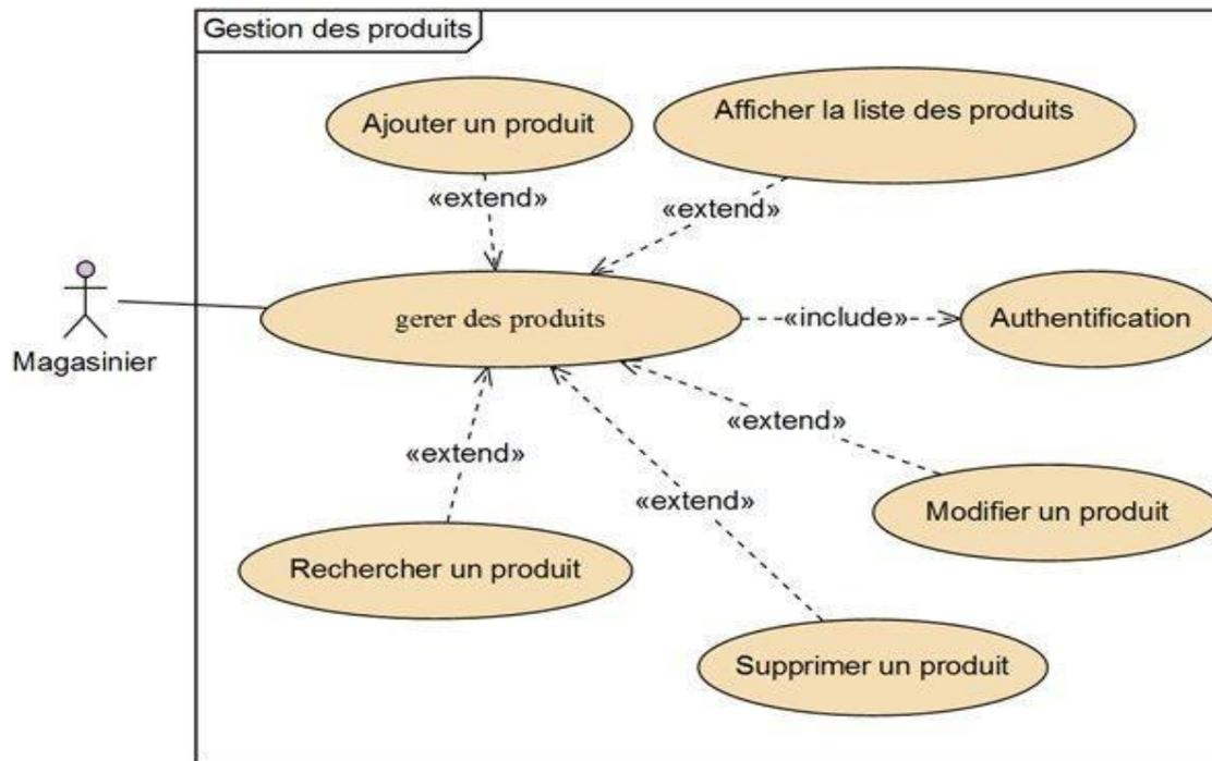
Figure 19 : Diagramme de cas d'utilisation «Gestion des produit finis» -Itération 1-
