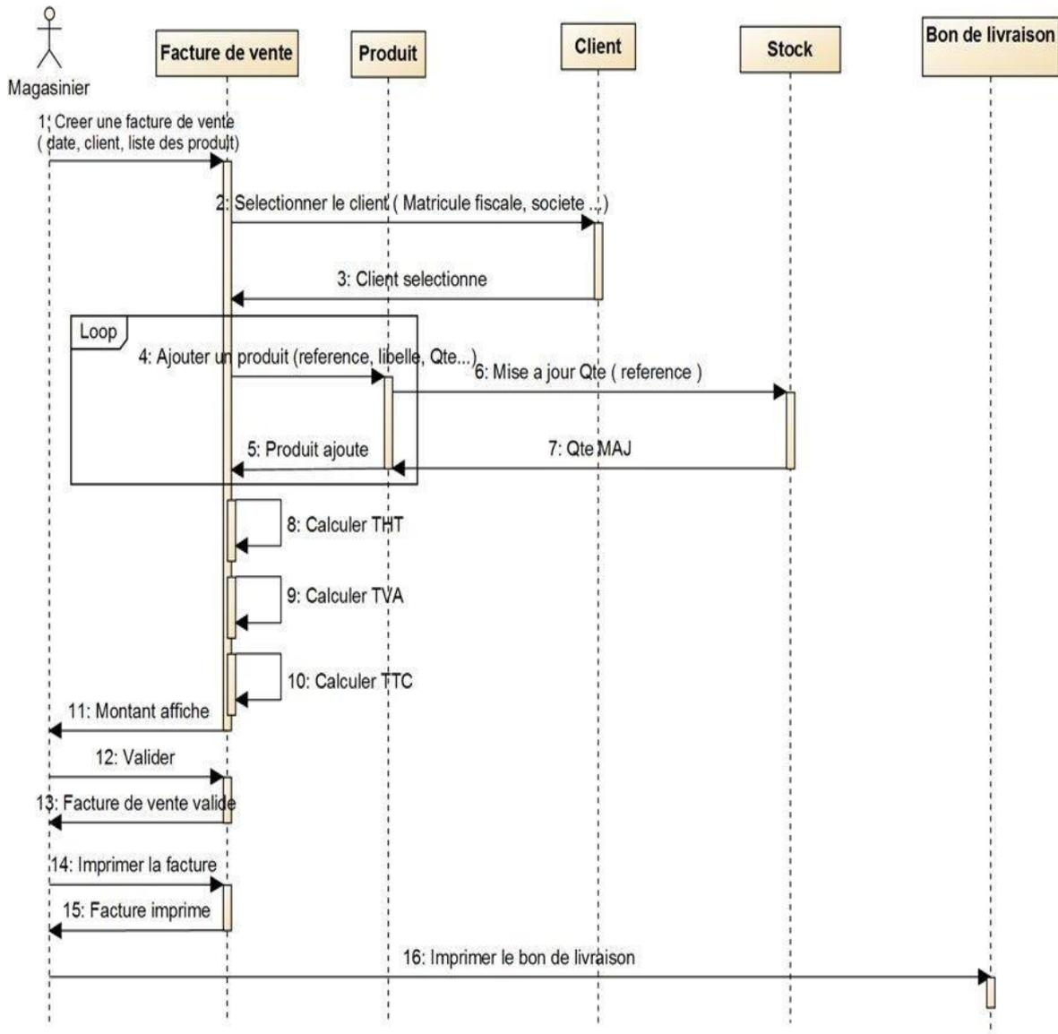
Figure 27 : Diagramme de séquence « Ajouter une facture de vente » - Itération 1 -
