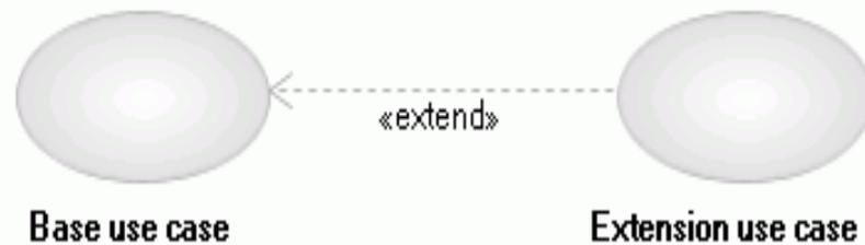
Figure 13 : Exemple d'une relation d'extension
