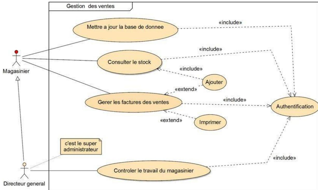
Figure 21 : Diagramme de cas d'utilisation « Gestion des ventes » - Itération 1 -
