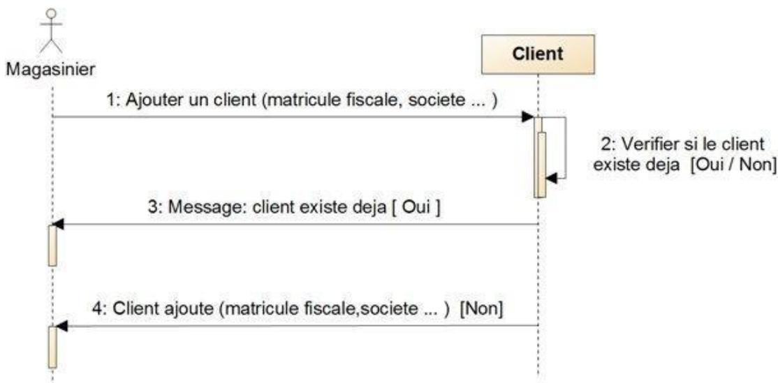
Figure 25 : Diagramme de séquence « Ajouter un client » - Itération 1 -
