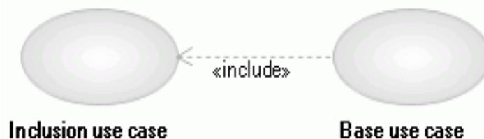
Figure 12 : Exemple d'une relation d'inclusion
