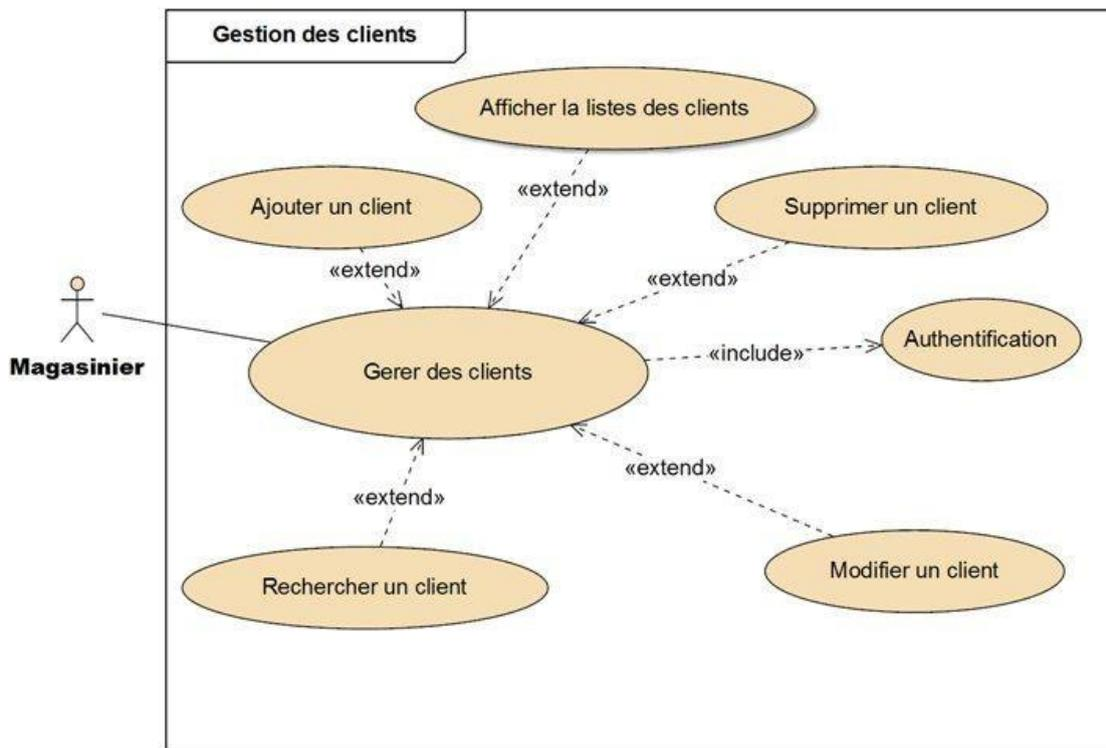
Figure 20 : Diagramme de cas d'utilisation « Gestion des clients » - Itération 1-
