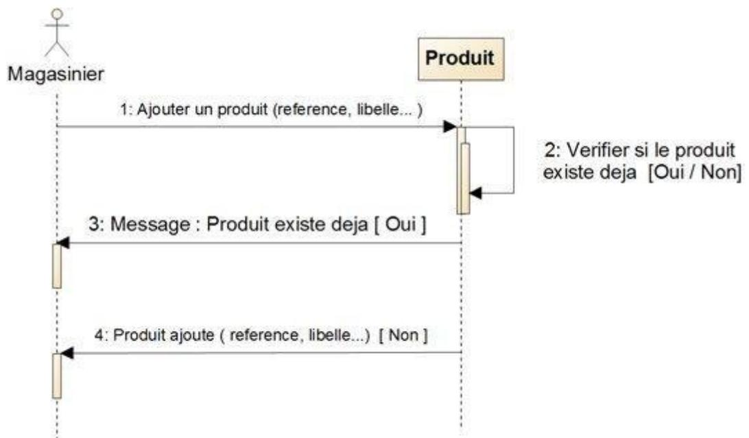
Figure 23 : Diagramme de séquence « Ajouter un produit » - Itération 1 -
