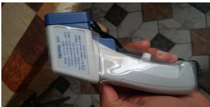
**Figure15 :** thermomètre infrarouge laser
