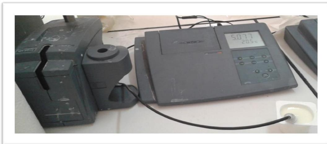
**Figure N°1 A:** pH mètre durant l'analyse de l'échantillon (photo originale).
