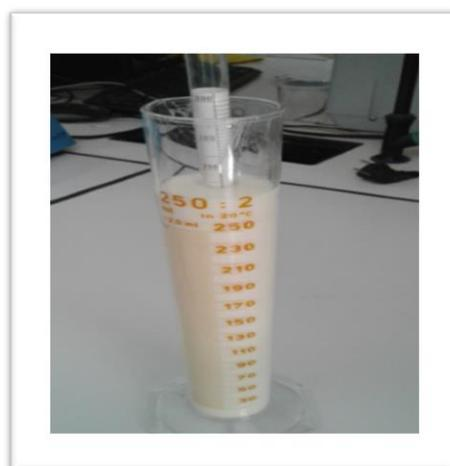
**Figure N°2 A** : la détermination de la densité (photo originale).
