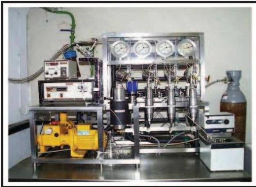
Figure 08 : Installation d'extraction au CO<sub>2</sub> supercritique de laboratoire (Iakhdar D, 2011).
