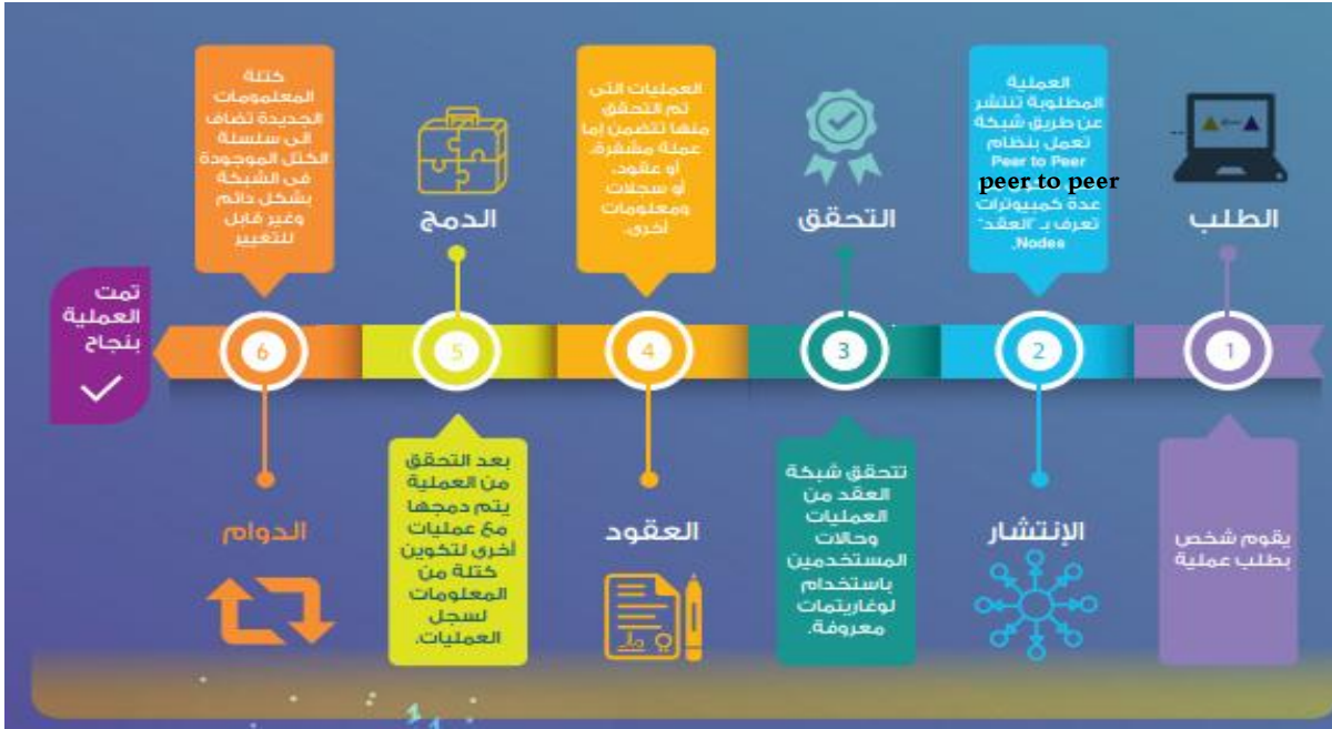
الشكل رقم (09): يوضح آلية عمل البلوك تشين من الناحية التقنية
