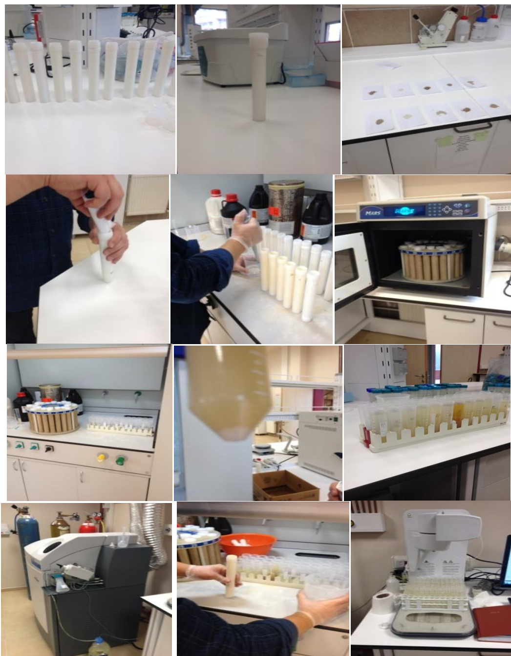
Figure 6 : Les étapes de digestion et de dosage des métaux lourds
