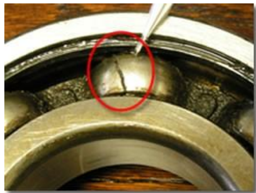
(b) défaut de cage à bille
