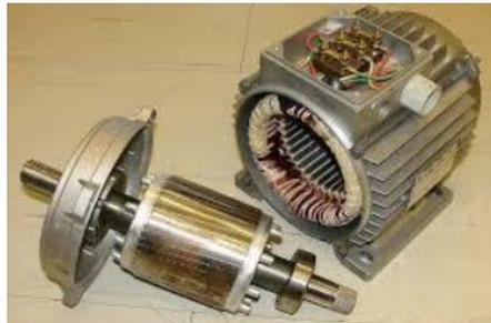
Figure 1.3 Stator (à droite) et rotor (à gauche) du moteur à courant continu.
