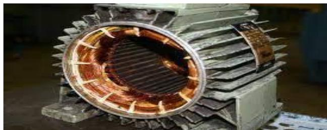
Figure 2 photographie d'un stator
