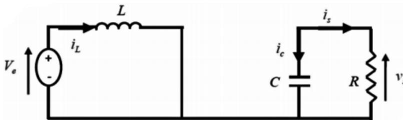
Figure2.5 Circuit équivalent du Boost quand l'interrupteur est fermé
