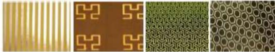
Figure I.1: Exemple de FSS imprimé
