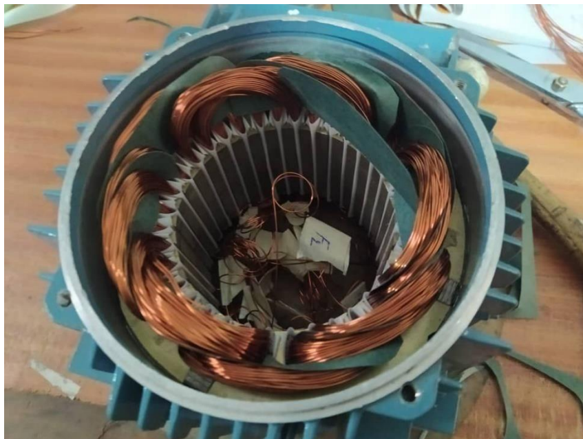
Figure III-11 : Les bobines de stator après l'isolation entre phases
