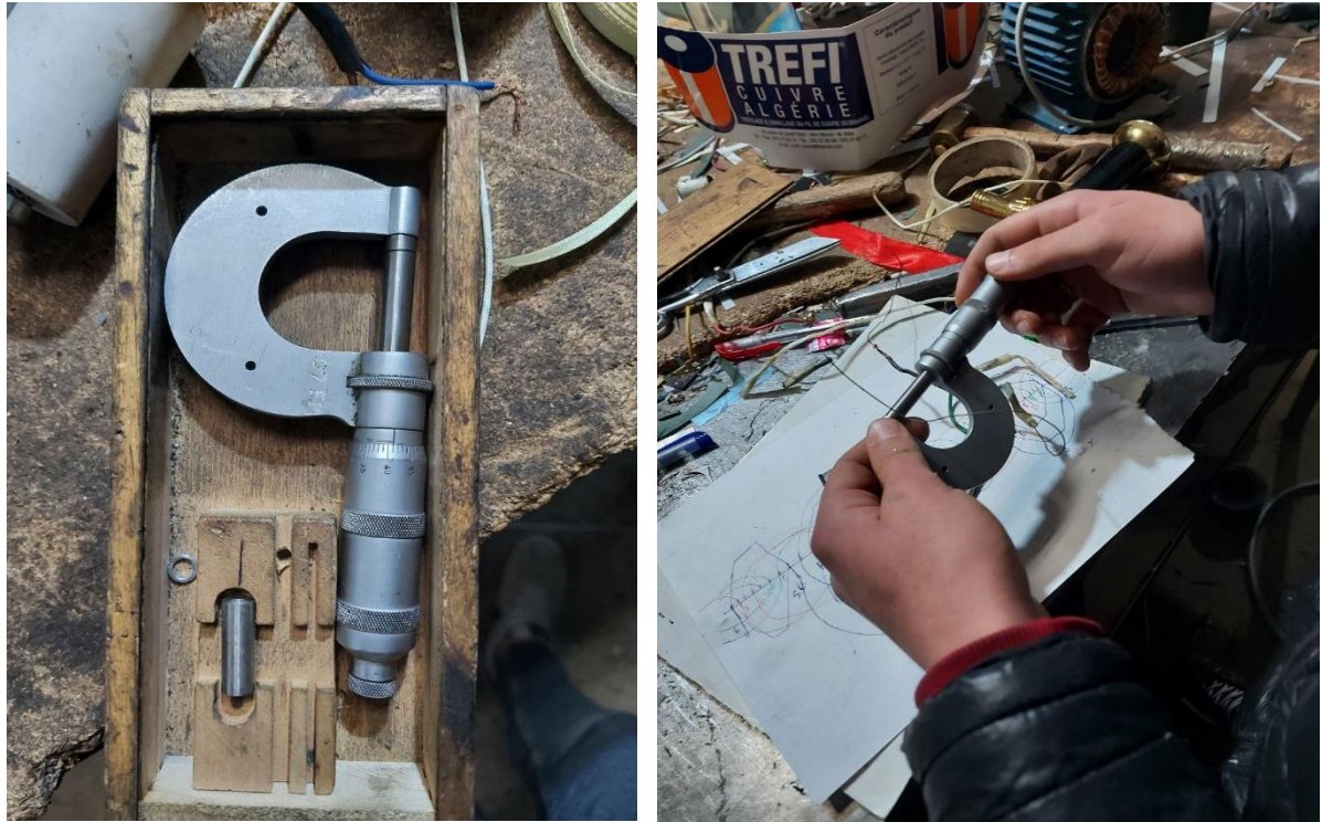
Figure III-5 : Micromètre (Palmer) pour mesurer le diamètre de cuivre
