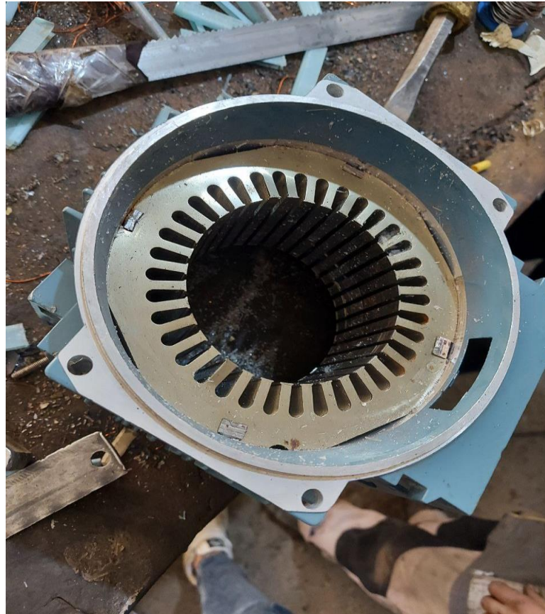
Figure III-3 : Le stator après le nettoyage
