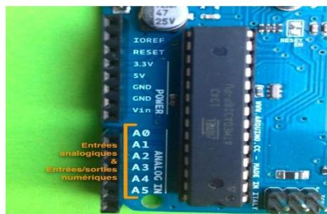
Figure 1.5:Entrées analogiques de l'Arduino Uno
