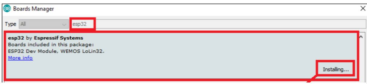
Figure 17: Installation du module ESP32 pour Arduino IDE (4)
