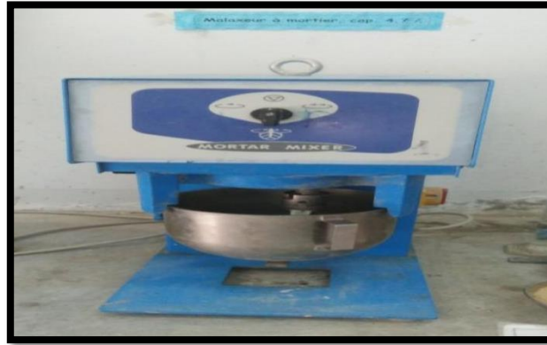
Figure II.5 : malaxeur normalisé EN 196-1.
