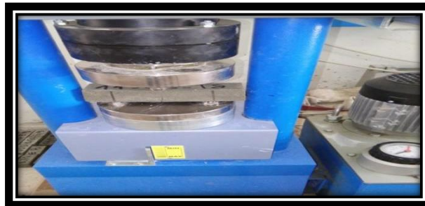
Figure II.10 : Dispositif expérimental de l'essai de flexion
