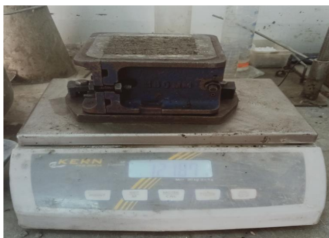
Figure 3. 7 : mesure de la masse volumique.
