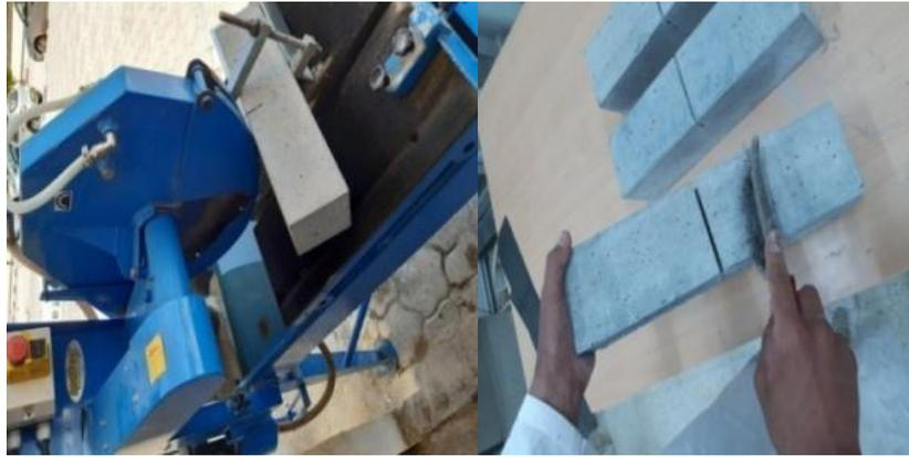
Figure 3. 9 Création de fissure et nettoyage.
