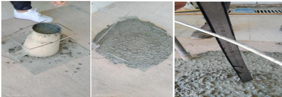
Figure 4. 1 Affaissement du BHP essai de cône d'Abrams.
