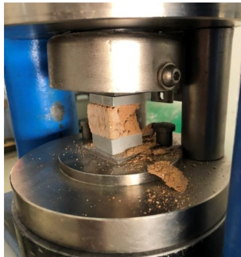
Figure III. 12 schéma de l'essai de compression
