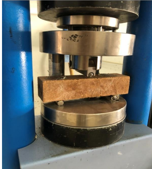
Figure. Essai de flexion sur mortier géopolymère.
