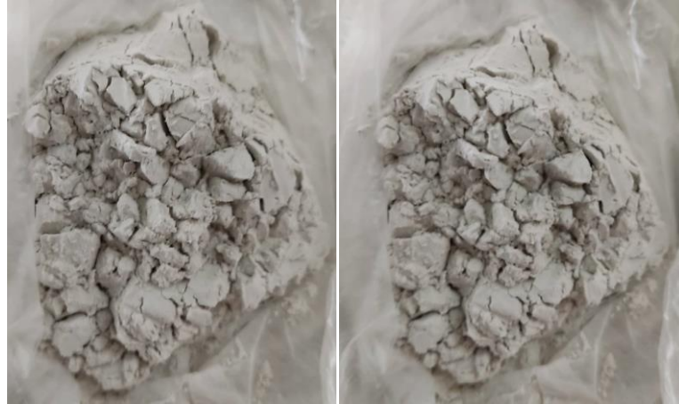
Figure III. 4Broyage de laitier.
