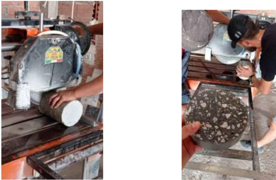
**Figure 18:** Le découpage des éprouvettes du béton.
