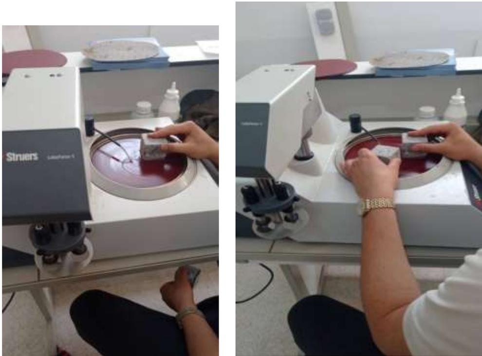
**Figure 19** : Rodage et polissage du matériau Bo BAP BHP.
