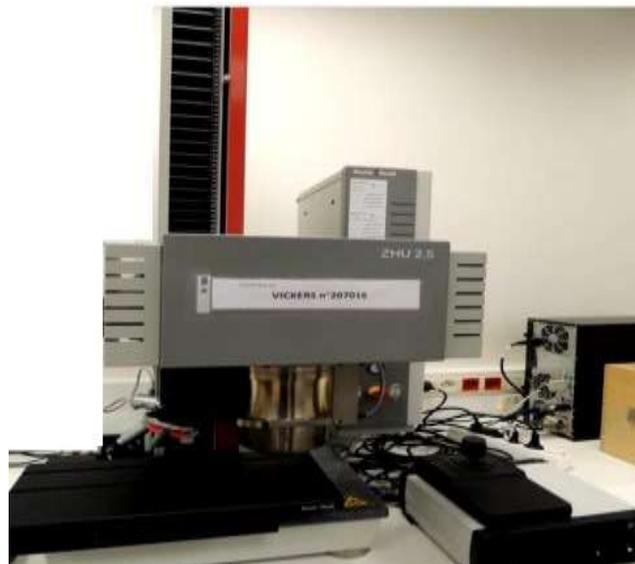
**Figure 8** : Machine d'indentation Zwick ZHU 2.5
