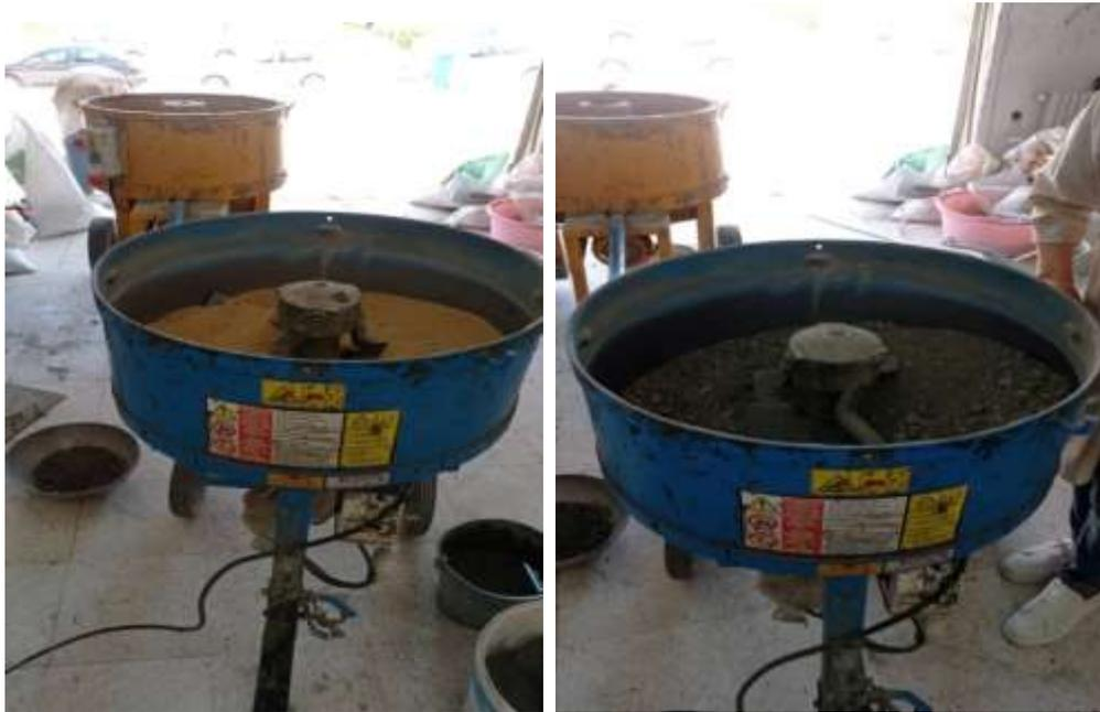
**Figure 16:** malaxage des matériaux au niveau de laboratoire.
