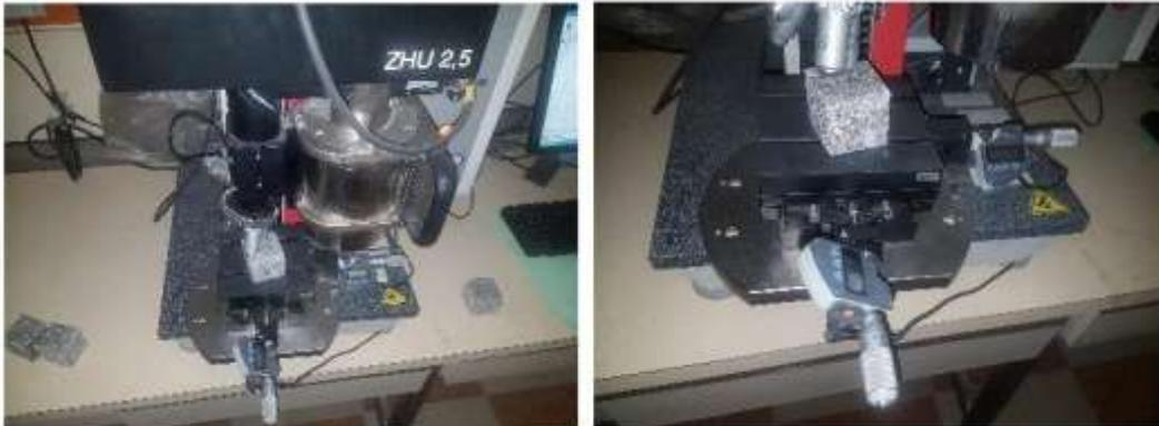
**Figure 11** : Plusieurs essais effectués sur le béton BAP au moyen d'indentation Zwick ZHU 2.5
