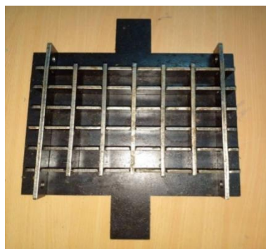
Figure 3. 7 Moule de coulage.
