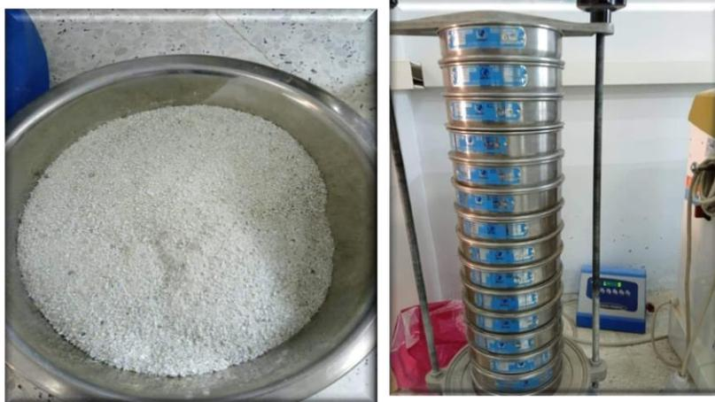
Figure III.3 : Les déchets du plastique transformé après le tamisage.
