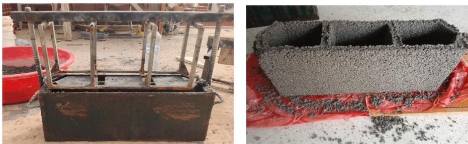
**Figure III.4 :** Le béton hourdis après 24h.
