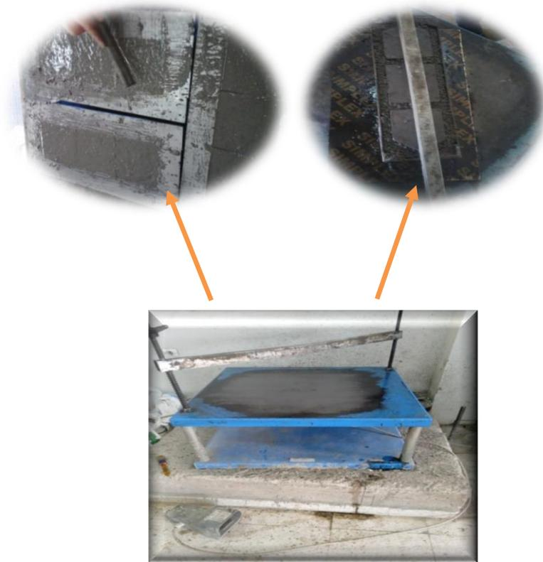
Figure III.7 : Vibration de moule l'ourdis et béton hourdis par table vibrante.
