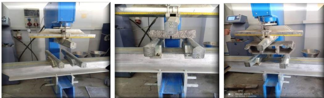
Figure III.12 : Machine d'écrasement d'hourdis.
