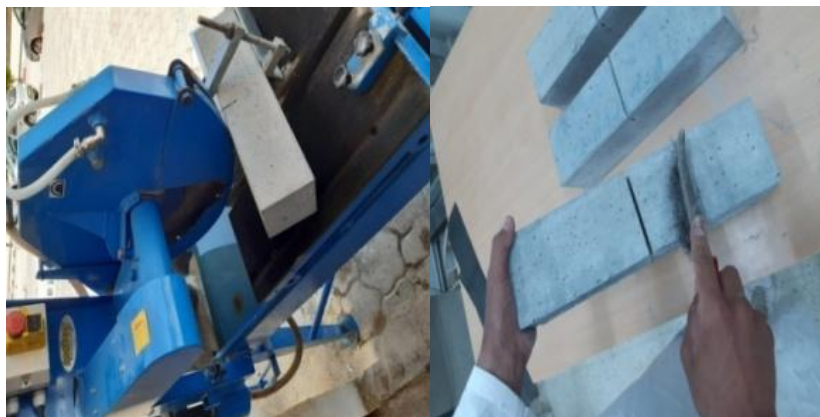
Figure 2. 9 Création de fissure et nettoyage.
