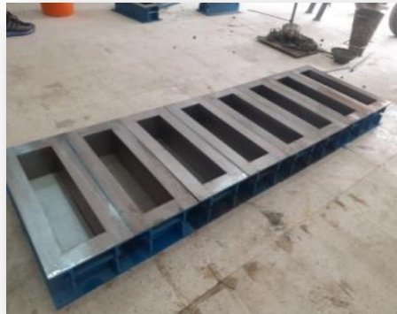
Figure 2. 3 Le coffrage utilisé.
