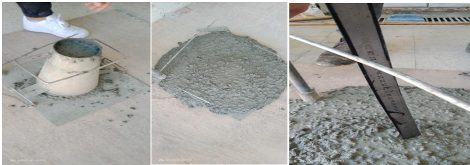
Figure 3. 1 Affaissement du BHP essai de cône d'Abrams.
