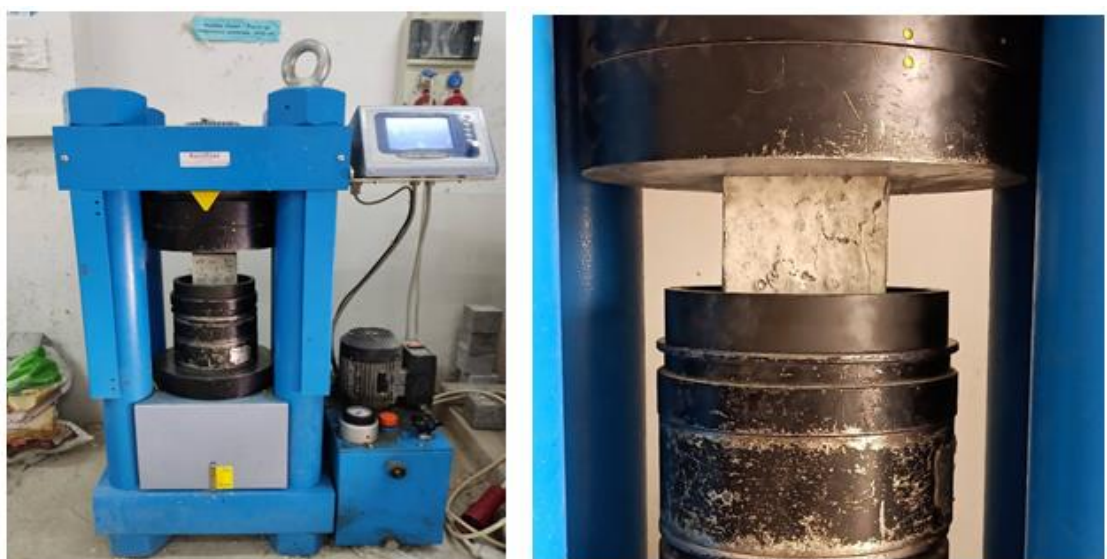
Figure III.9. L'essai de compression (au laboratoire GC)
