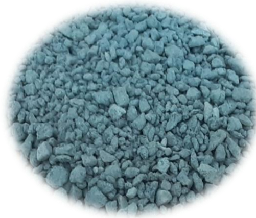
5-Granulats pulvérisés au Medacure et puis à la poudre de verre (Granulats traités)
