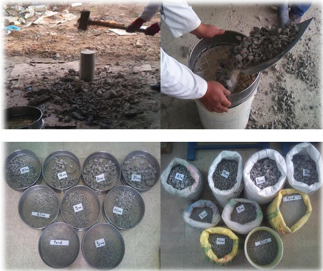
Figure III. 3: Concassage, criblage, tamisage et séparation des agrégats recyclés.
