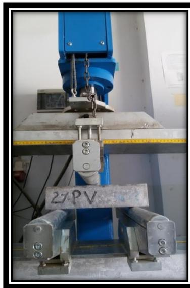
**Figure 1.8** *Mesure* de la résistance à la traction par flexion
