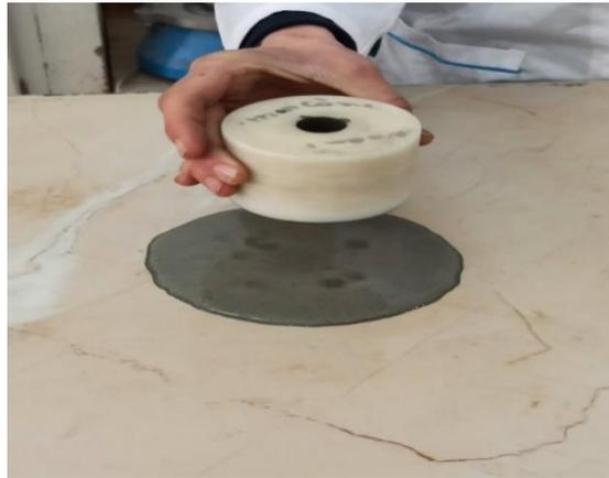
*Figure3.5. Détermination du point de saturation au mini cône (labo. de GC)*
