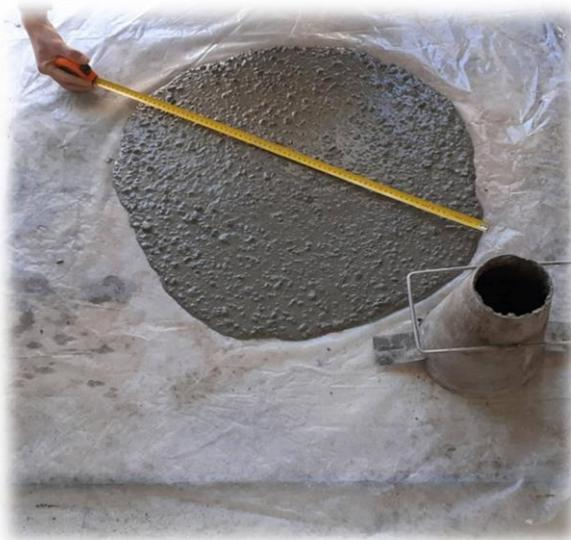
*Figure 3.6. Essai d'étalement (laboratoire de génie civil)*
