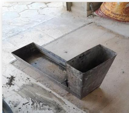
*Figure 3.8. Essai de la capacité de remplissage (laboratoire de génie civil)*
