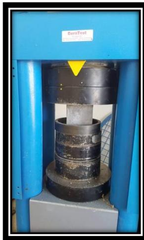
*Figure 1.7. Mesure de la résistance à la compression*
