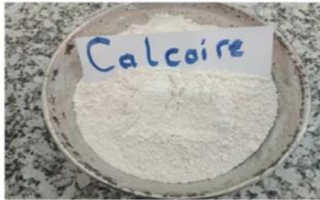
*Figure 3.3.Fillers de calcaire*
