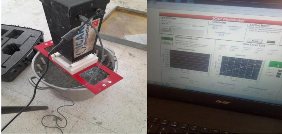
**Figure 3.9. Essai de Rhéomètre ICAR (laboratoire de génie civil)**
