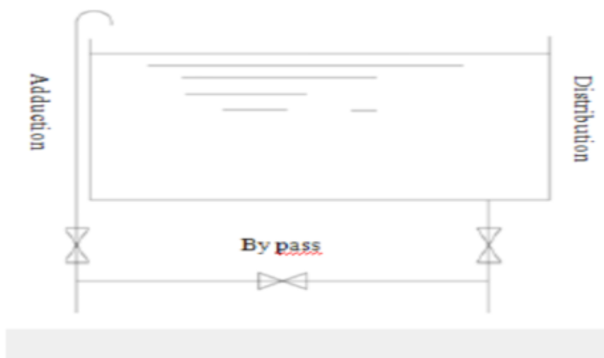
Figure 16- By-pass d'un réservoir.
