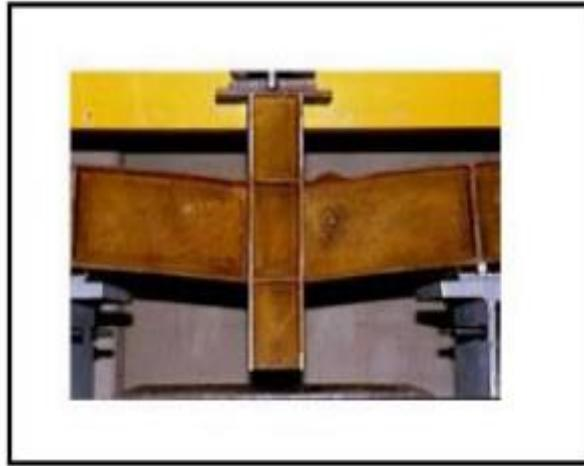
**Figure IV.7 :** Voilement local de la membrure de l'amé supérieure.
