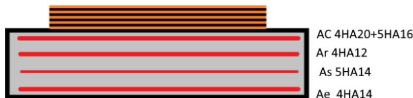
Fig. VI.9 Ferrailage de dés d'appui.
