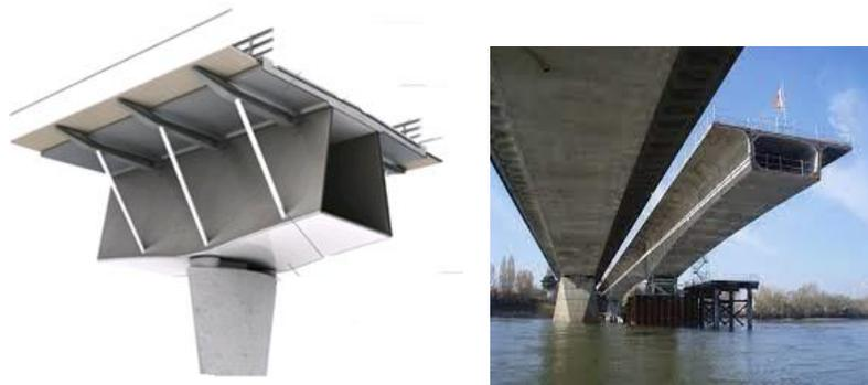
**Fig. I.24 : Schéma descriptive d'un pont mixte caisson**
