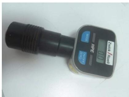
*Figure 6:* Instrument de mesure de la dureté Shore D.
