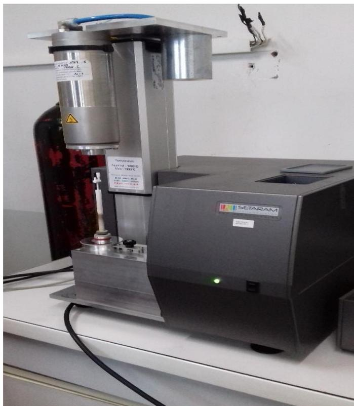
Figure II.27: Appareil d'analyse thermogravimétrique SETARAM ATG/ATD evo
