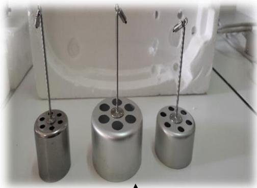
Figure II.2 : Rotors du viscosimètre
