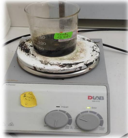
*Figure II.22* : Agitation de l'huile avec gel de silice
