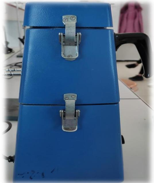
*Figure II.16* : Broyeur de laboratoire
