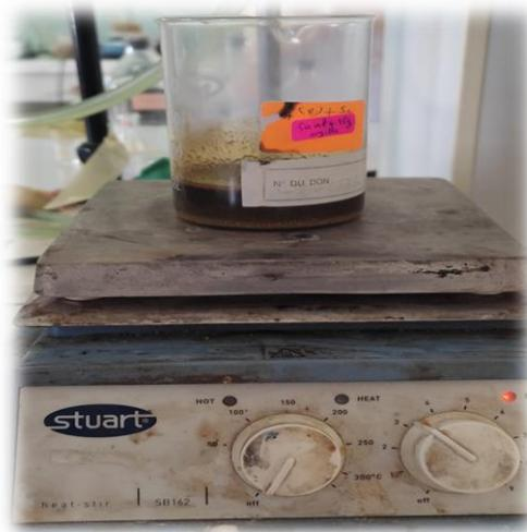
**Figure II.20** : Agitation de l'huile avec l'argile
