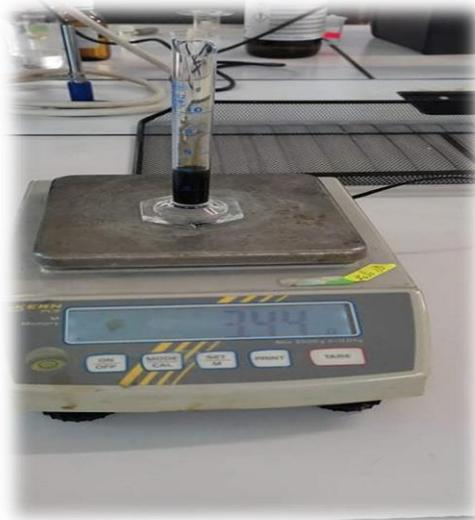
**Figure II.4:** Mesure la densité par pesée
