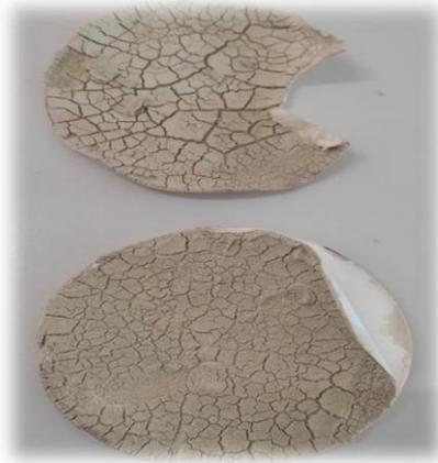
**Figure II.19** : Séchage de l'argile après filtration
