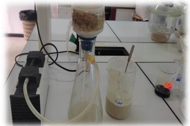
*Figure II.18* : Filtration de l'argile lavée
