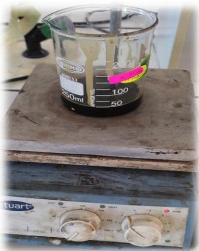
Figure II.13: Agitation de l'huile avec H<sub>2</sub>SO<sub>4</sub>
