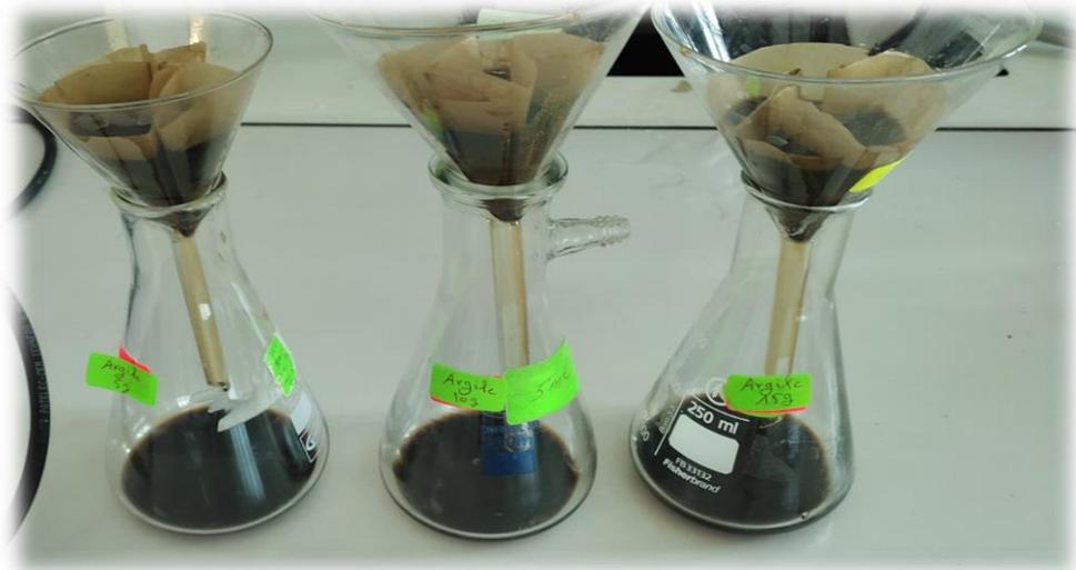
*Figure II.21* : Filtration d'huile traitée avec l'argile lavée
