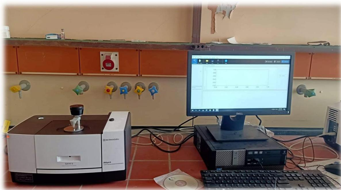
**Figure II.26:** Appareil de spectroscopie infrarouge à transformée de fourrier (FTIR Q-ATR-S)
