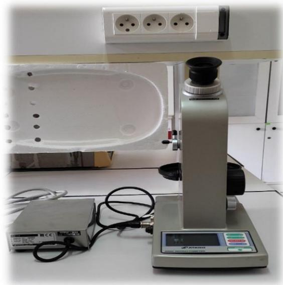
Figure II.6: Réfractomètre Abbe (ATAGO)
