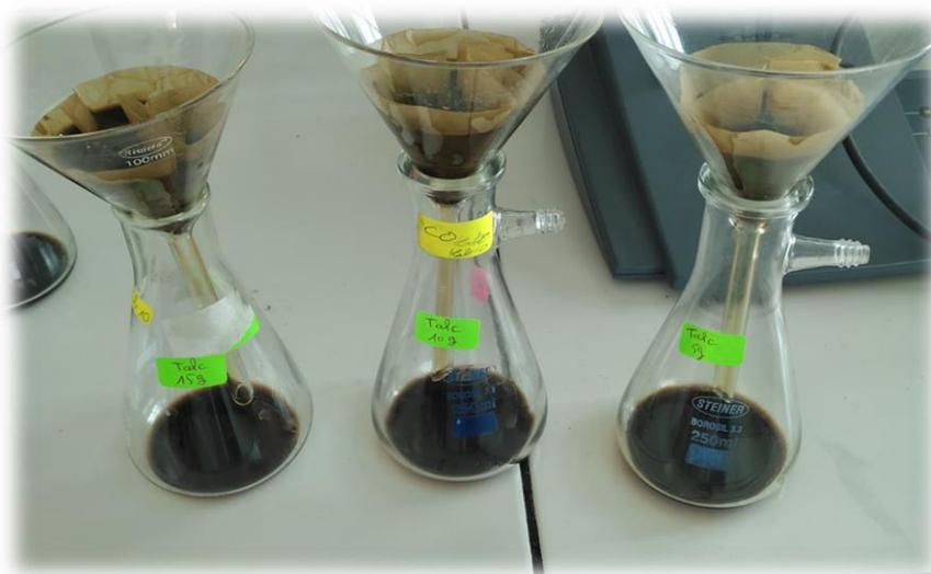
Figure II.25: Filtration de l'huile traitée par le Talc
