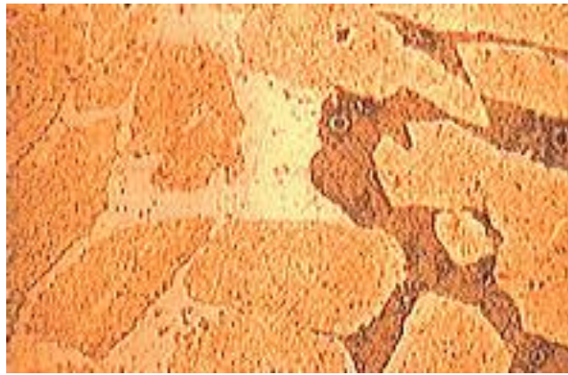
Figure I.5 : Coupe métallographique montrant une corrosion sélective d'un laiton.
