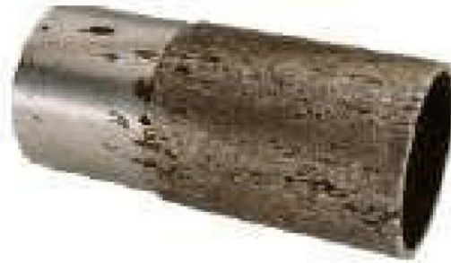
Figure I.3 : Corrosion par piqûres
