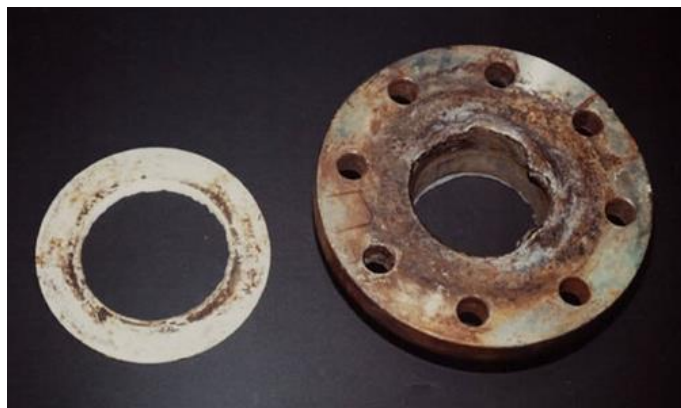
Figure I.6 : Corrosion caverneuse d'un acier allié sous un joint
