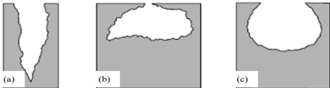
Figure I.4 : Formes de piqûres (a) cavité profonde (b) cavité cavernueuse (c) hémisphérique.
