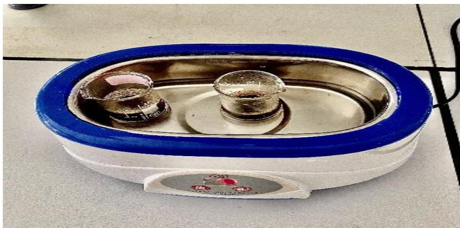
**Figure 21** : Eviter l'agrégation des particules par un sonicateur.
