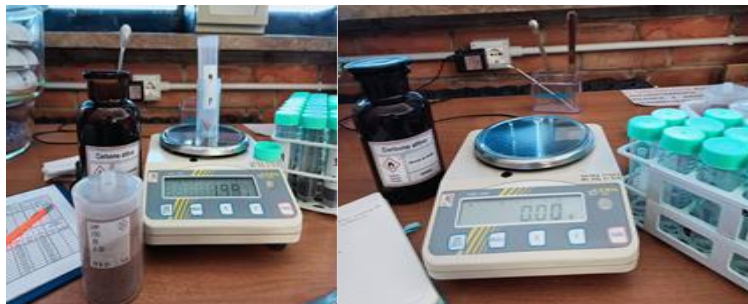
Figure 25 : Mesure du poids du sol et charbon actif.
