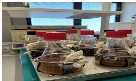
Figure 32 : Agitation des sols pour détermination de texture.
