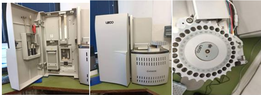
Figure 40 : Four toure à température très élevée (900 °C).
