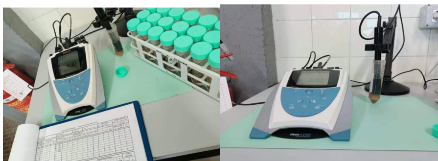
Figure 24 : Représente la lecture de conductivité électrique ( \mu\text{S}/\text{cm} ).
