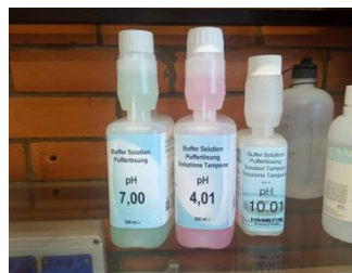
Figure 18: Solution d'étalonnage de pH-mètre .
