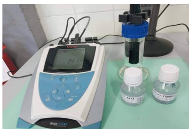
Figure 23 : Représente les solutions d'étalonnage d'un conductimètre.
