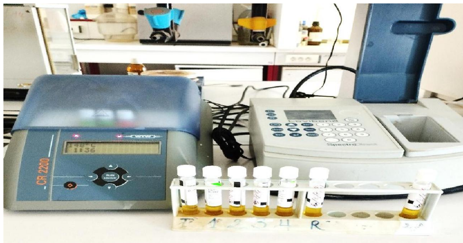
Figure 12 : Réacteur thermique préchauffé et spectrophotomètre pour la mesure de la DCO.
