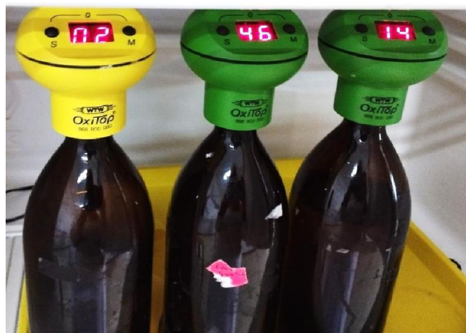
Figure 11 : Flacons de mesure de DBO 5 .
