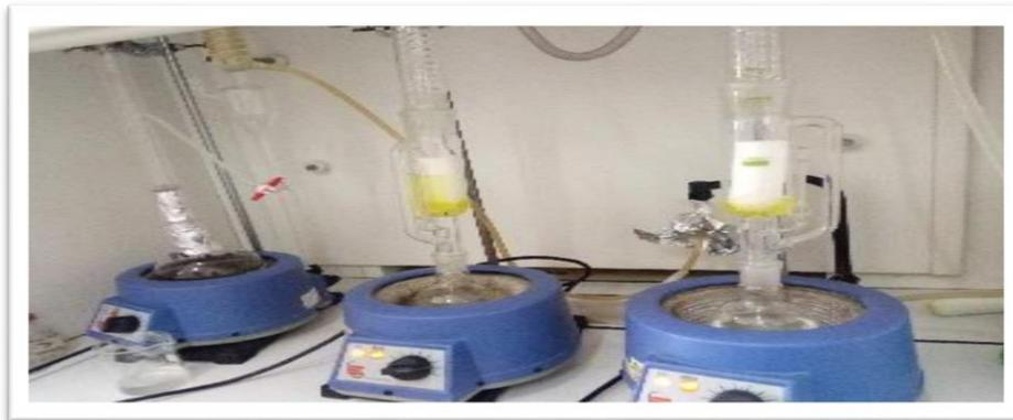
**Figure 2:** L'extraction de la matière lipidique par Soxhlet.
