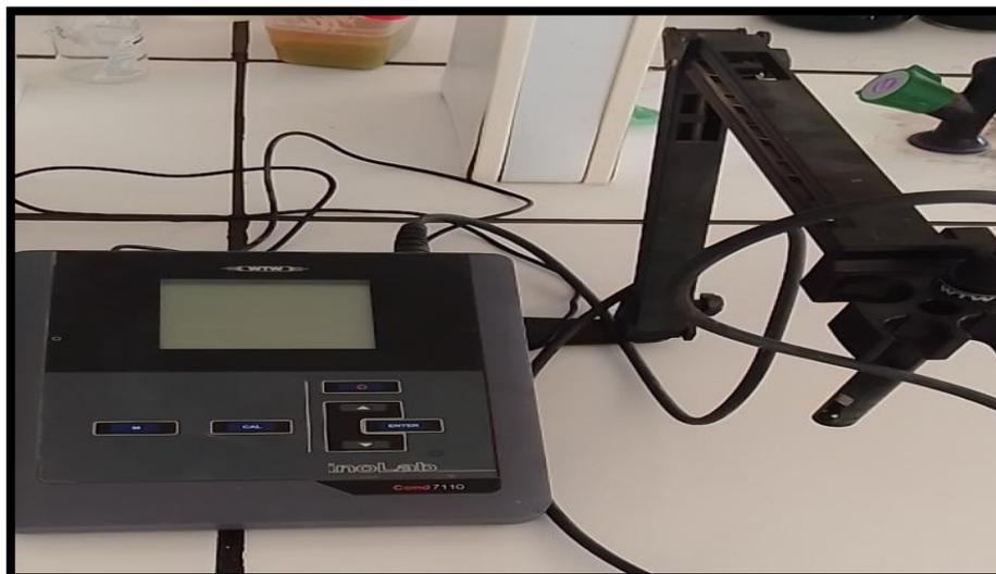
**Figure I-3 :** Conductimètre de paillasse inolab™ 7110.
