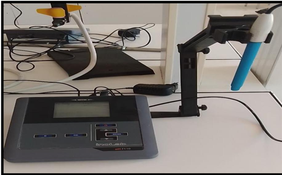
**Figure I-2 :** pH-mètre de paillasse inolab™ 7110.
