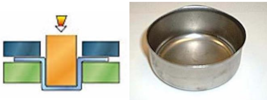
Figure I.5 Emboutissage en retraits [2,7]
