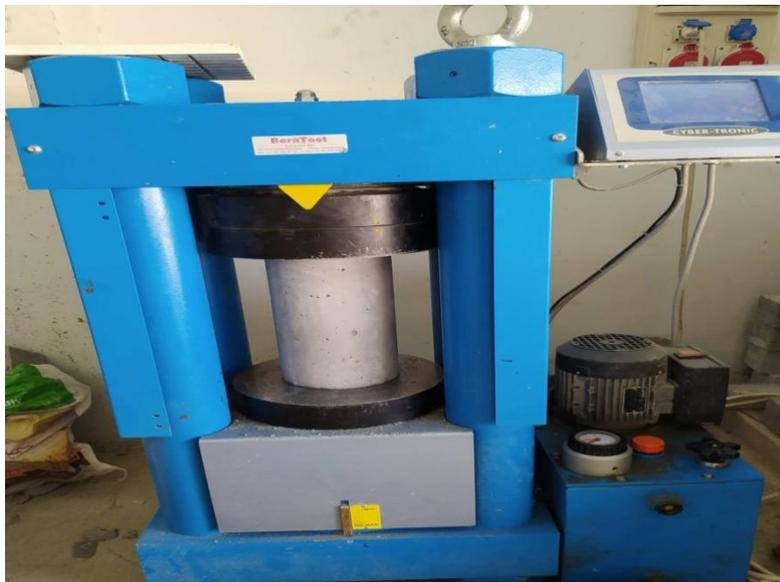
Fig 3.4 essai de compression avec machine "BeraTest AG"
