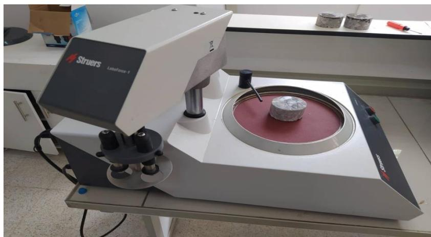
Fig 3.2 Principe de rodage et polissage du matériau par une polisseuse Struer
