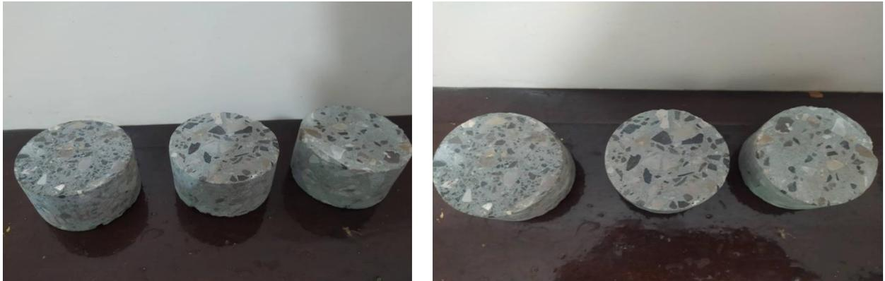
Figure 3.3 : Les échantillons des BO,BAP,BHP poli par des papiers abrasifs
