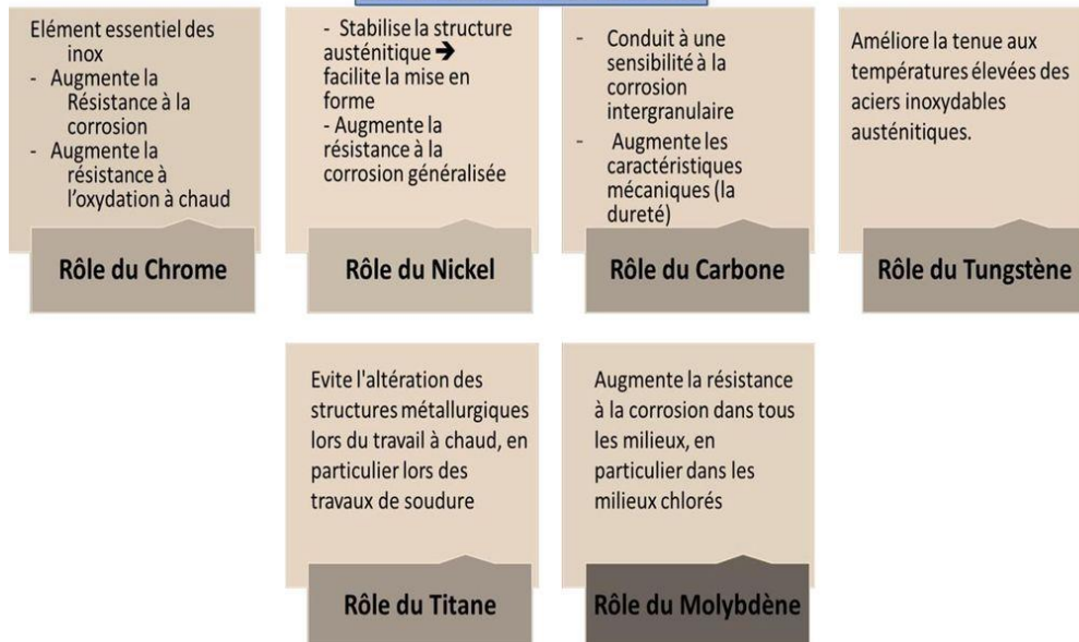
Figure.1.2. Les constituants de l'acier inoxydable et leurs rôles. [6].
