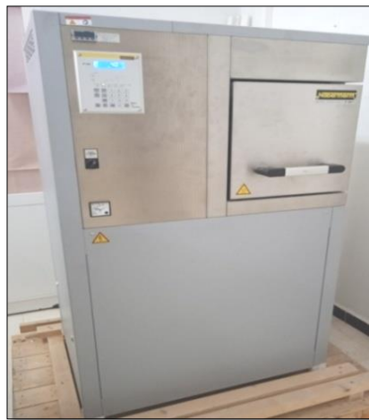
Figure. 2.4. Four pour traitement thermique, marque NABERTHERM gamme de température entre 30°C et 3000°C.
