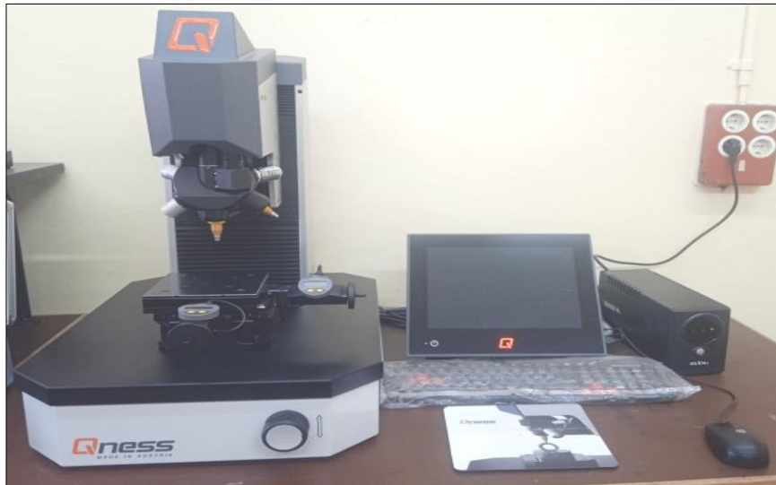
Figure.2.7. Micro-Duromètre Q30, marque Qness, logiciel QpixT2
